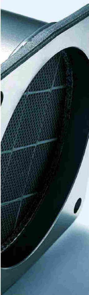
I filtri tradizionali svolgono un'azione meccanica di raccolta del soot che poi va trattato, sostanzialmente per combustione, e trasformato in ossidi di carbonio. Nel progetto Partial PGMs, invece, sul filtro è depositato del materiale attivo che converte il soot contemporaneamente all'abbattimento degli inquinanti gassosi.
