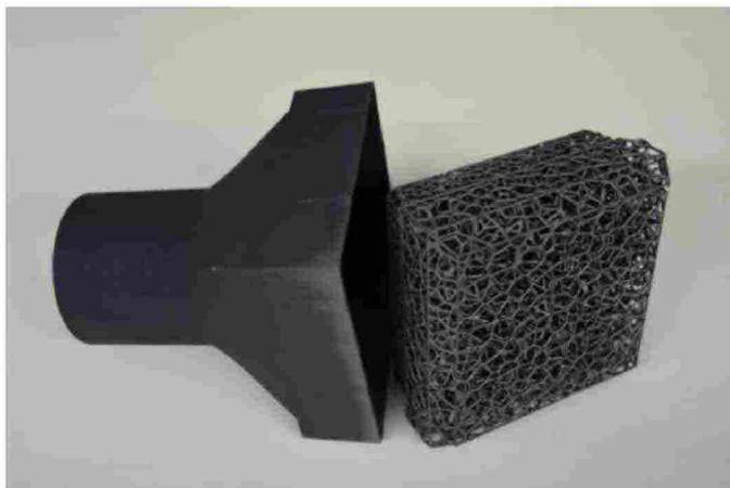
*Singolo ricevitore ceramico prodotto da Liqtech e Engicer / Fonte ENEA.*
